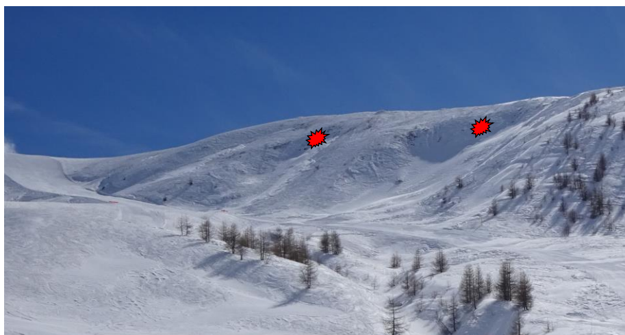
Figure VI-1 : positionnement proposé pour deux éventuels déclencheurs automatiques.
