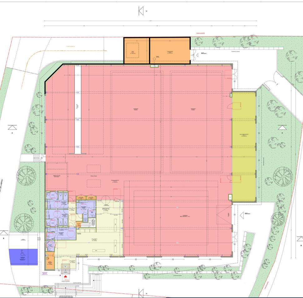
A l'intérieur du bâtiment, afin d'offrir une grande flexibilité dans l'aménagement des terrains de sport, une charpente de plus 30 m de portée, sans point d'appui intermédiaire, a été retenue pour couvrir les terrains de sports. Cette structure permettra de réaménager facilement les terrains de sport dans le futur.
